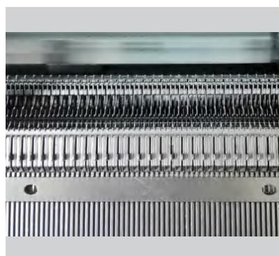
交叉式沉降片设计，由系统控制压纱深浅，适合较厚实的填充织物和护膝、手套等特殊织物的编织
